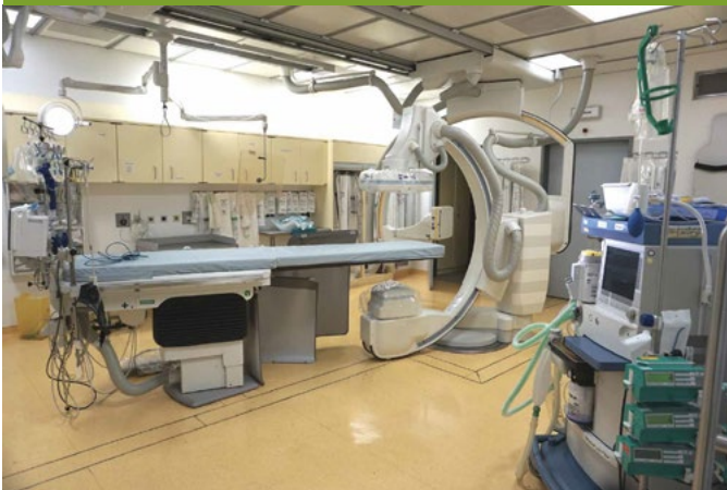
Röntgen-Angiographie-Anlage: digitale Bildgebung durch Halbleiter-Flachdetektoren
